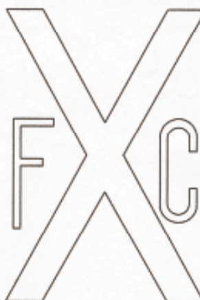
SEÑALIZACION PINTADA EN LA PISTA ANTES DE UN CRUCE A NIVEL
